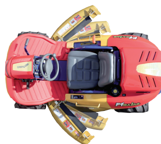
Ouverture latérale des carters pour changement des lames.
