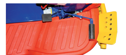
Commandes hydrostatiques doublées (volant, pied)
