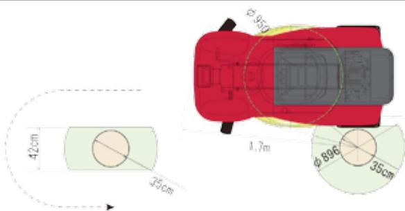
Roues avant pivotant à un angle de 75° et blocage des roues arrières.
