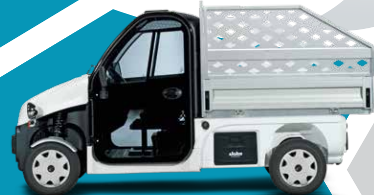
6 Plateau 3 ridelles + réhausse aluminium et porte-outils
