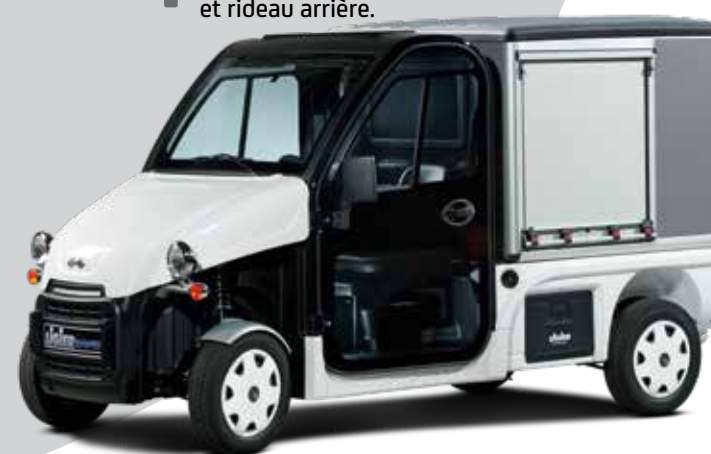
4 Coffre avec volet roulant avec rideau latéral droit ou gauche et rideau arrière.
