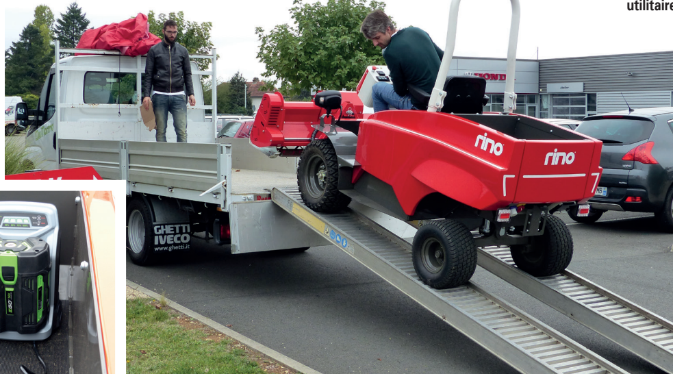
Le Rino sert de source d'énergie. A l'arrière, une prise permet d'alimenter des outils ou de recharger des batteries.
