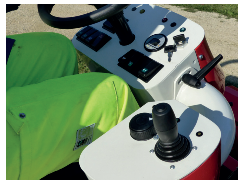
Le poste de conduite avec la console et le joystick, la colonne est réglable.
