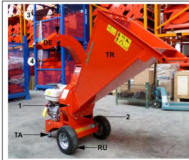
1. Extraire du carton la machine “MAH”, la trémie “TR”, le déflecteur de déchargement “DE”, les 2 roues “RU”, les 2 pieds élastiques d'appui “TA” et les manuel d'emploi et entretien de la machine et du moteur.
