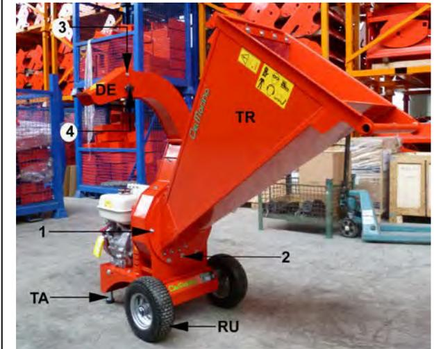
1. Extraire du carton la machine "MAT", la trémie "TR", le déflecteur de déchargement "DE", les 2 roues "RU", les 2 pieds élastiques d'appui "TA", l'étrier du III° point "SU", le III° point "TI", la protection "CU" et les manuels d'emploi et entretien de la machine.
