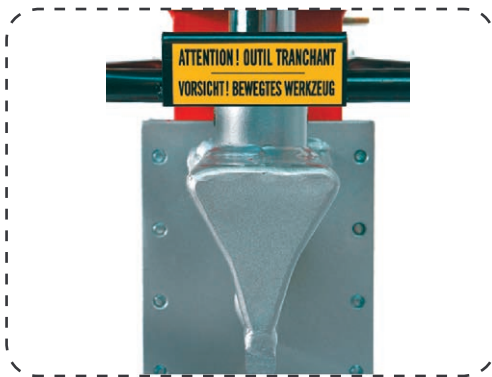
Couteau ergonomique de forme éclateur pour fendre avec moins d'effort. Incliné pour favoriser le maintien du bois.
